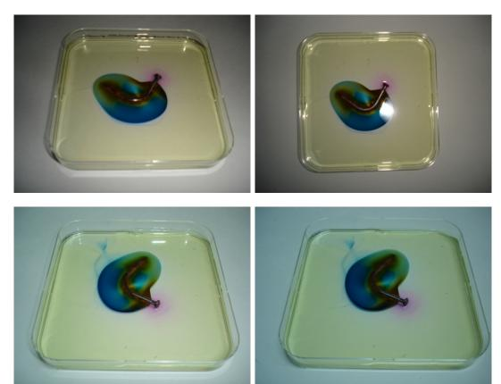
Agar + Fe +  $K_3$ [Fe(CN<sub>6</sub>)] + Fenolftaleína + Zn + HCl Se observa la aparición de burbujas
