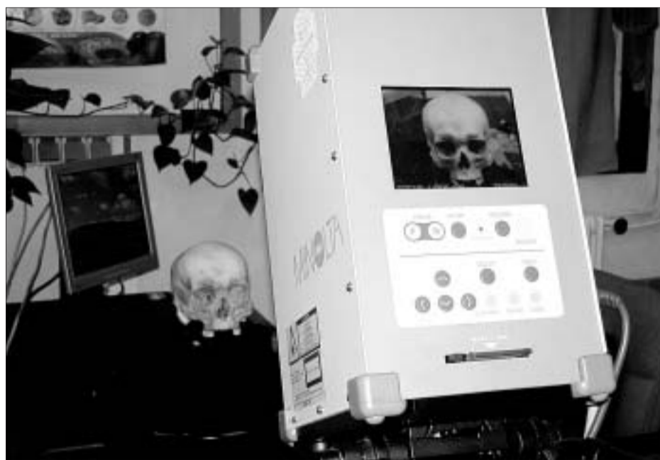
El cráneo, que se sitúa en una tabla rotatoria, es registrado por el escáner.
