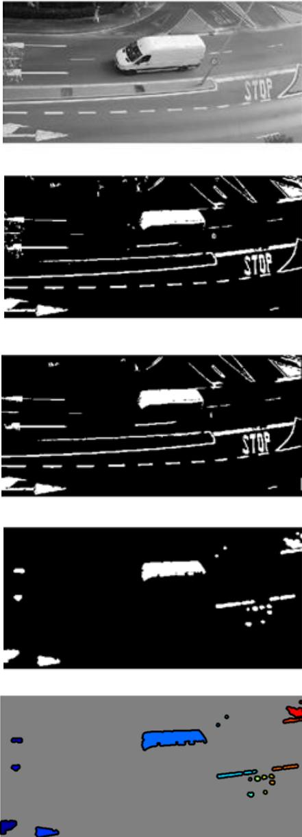
**Figura 3. Caso Práctico Visión Artificial 1: Contador de Vehículos en Vídeo.** Determinación del número de vehículos en una serie de frames de vídeo. Se muestra la detección realizada en un frame. Se usa un algoritmo muy sencillo que trata de detectar las regiones mayores de una cierta cantidad de píxeles después de realiza varias operaciones típicas de *image processing*.
